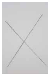
Aluminium | 1-Schicht pulverlack | 1008 Std AASST
