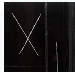
Aluminium | Epoxidharz + Topcoat | 1008 Std AASST
