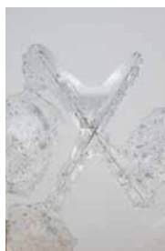
Aluminium | 1-Schicht pulverlack | 1008 Std AASST
