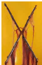
Stahl | 1 Schicht Pulverbeschichtung | 1008 Std NSST
