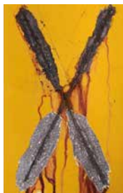
Stahl | 1 Schicht Pulverbeschichtung | 1008 Std NSST
